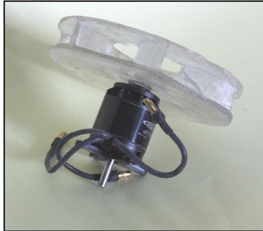
Turbine directement montée sur le moteur. Réalisation en résine polyester: technologie abandonnée pour motif de poids trop important donc balourd.
