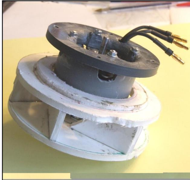
La turbine est conforme aux spécifications de J.Hamel dans le cas présent elle a pour diamètre 120mm et les pales 25mm de largeur.
