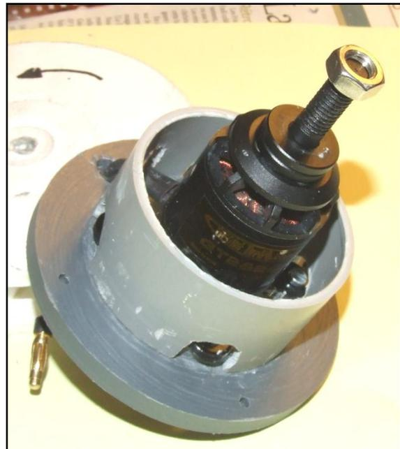
La turbine est fixée sur le nez du moteur, le tube en PVC entre légèrement (environ 2mm) dans la turbine avec un jeu radial de 2mm également
