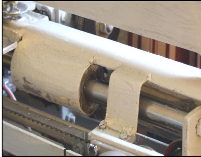
Un montage à trois roulements à bille permet de maintenir la platine en position verticale sans perturber le guidage obtenu par les douilles à bille
