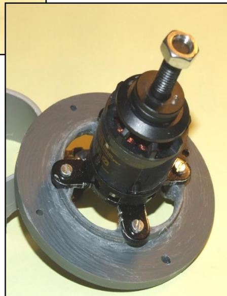
Le support est en PVC de façon à être positionné sur la volute au moyen de vis.
