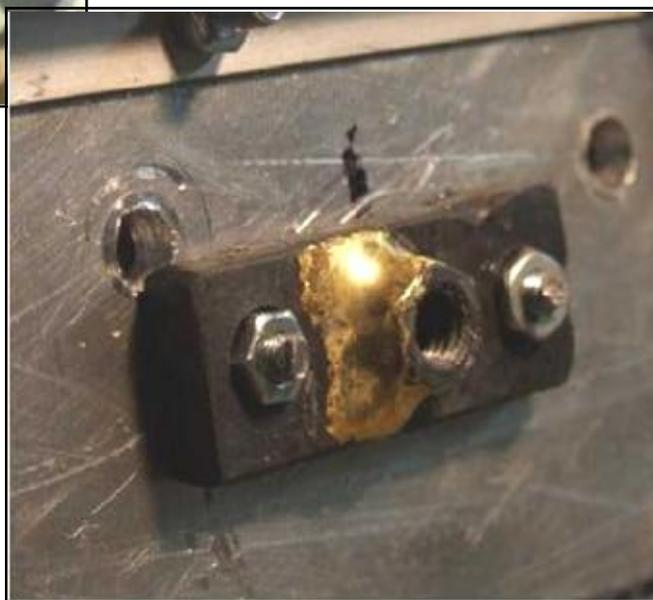
Support de vis de réglage longitudinal
