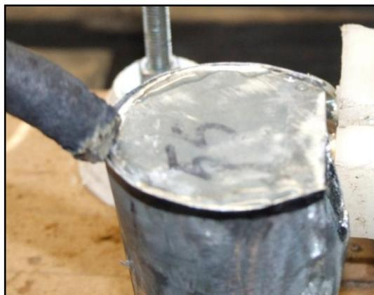
Soudure de l'opercule sur le cône
