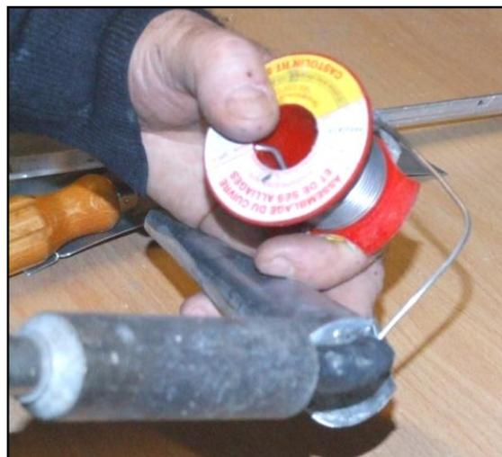
Il est recommandé d'employer un fer à souder de 1000 watts environ. L'étain pourra de préférence être à âme décapante ce qui évitera l'emploi de chlorure de zinc qui risque de tacher le métal
