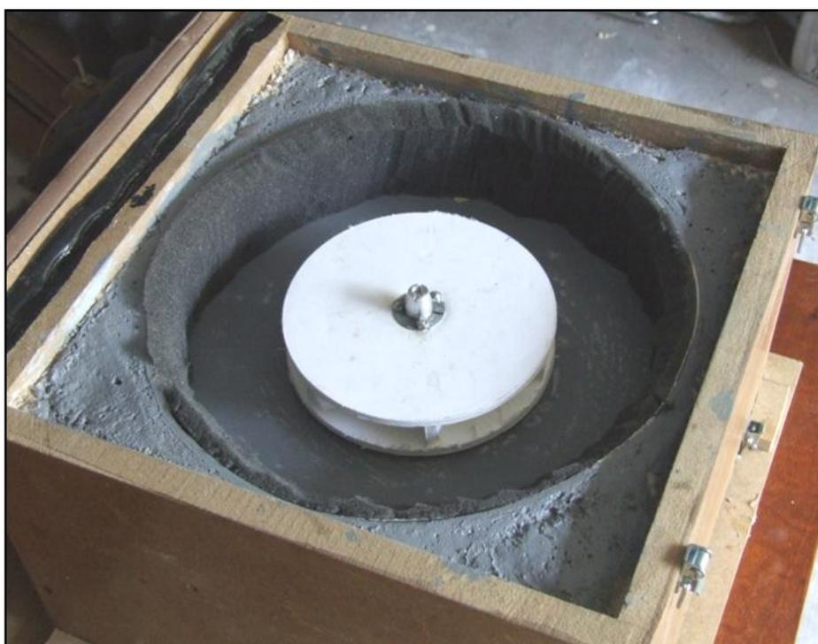
Le diamètre intérieur de la volute est environ le double du diamètre de la turbine
