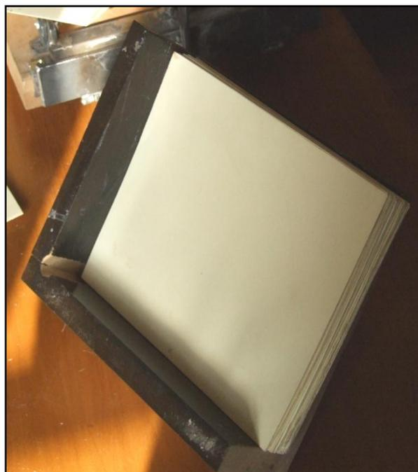
Après cette opération, on passera sous presse pendant environ **une minute, pas plus**, de façon à ce que la colle se répartisse correctement et uniformément. sur la carton encollé.
