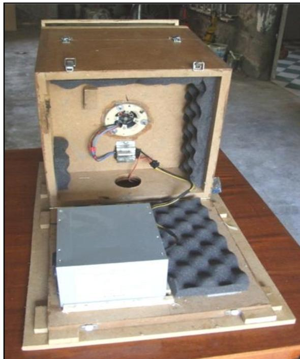
Boîtier d'aspiration position ouverte avec alimentation du moteur
