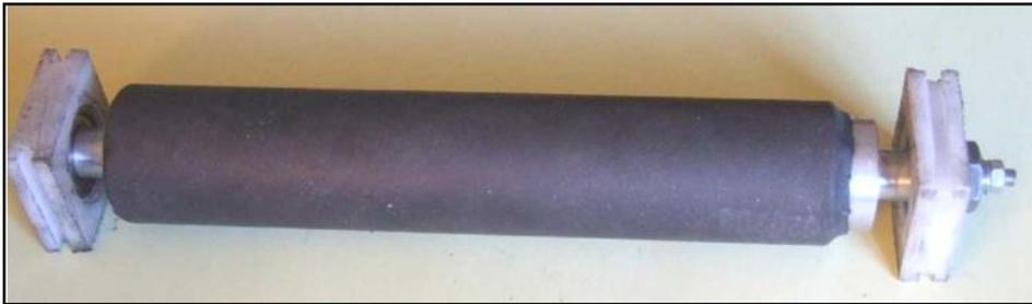
Le rouleau presseur et le rouleau d'entraînement sont montés sur un équipement munis d'une charnière afin de permettre la mise en place du carton.
