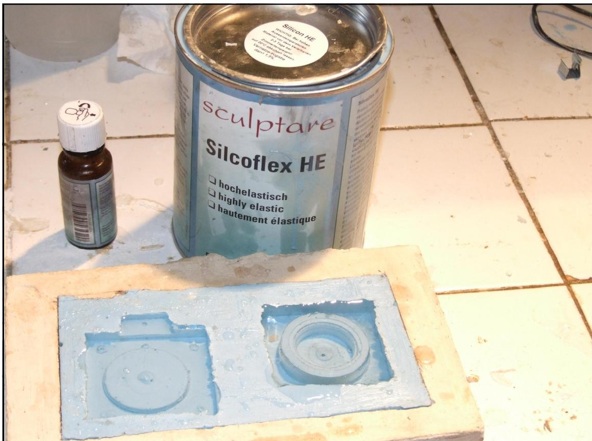
Les vannes obtenues par moulage sont confectionnées au moyen de résine époxy (bis phénol A). En effet cette dernière se prête beaucoup mieux au perçage des trous et son aspect transparent permet de voir si la membrane est correctement positionnée.
