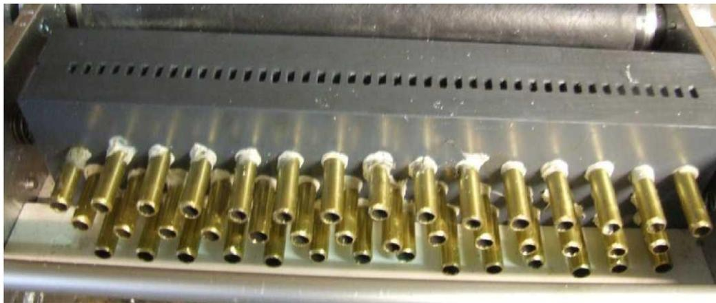
Les sorties se font sur des tubes en laiton de  $\varnothing$  6 mm
