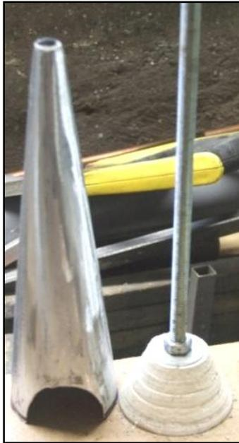
Dispositif permettant d'aligner le cône afin qu'il se positionne dans l'alignement du tube
