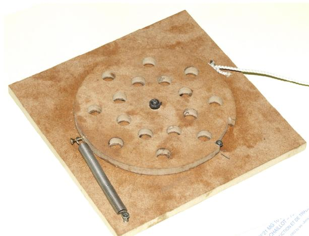
La ficelle reliée au soufflet du réservoir fait pivoter le robinet de 10° environ dégageant les orifices de passage du vent. Elle est directement reliée au soufflet de la boîte à vent par une biellette.
