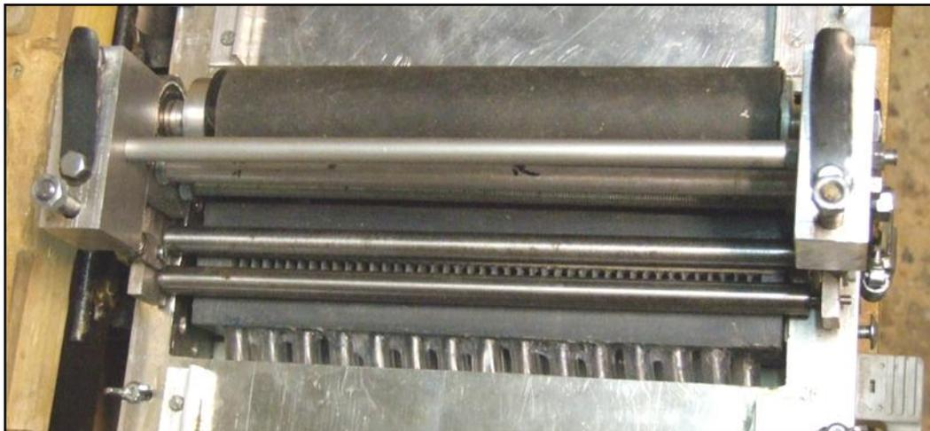
L'intérêt est en outre de pouvoir en permanence constater que les trous du cartons correspondent bien à ceux de la flûte de pan.
