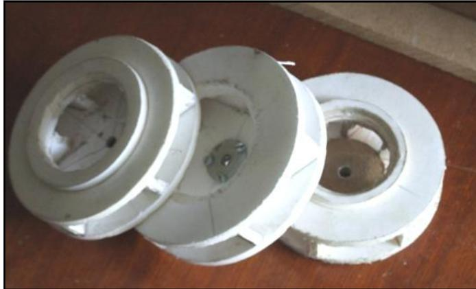
Ne possédant pas de débitmètre le critère retenu à été celui du courant électrique absorbé pour une même pression (80 mm d'eau) tout en notant grâce au sonomètre l'intensité du bruit généré par la turbine.
