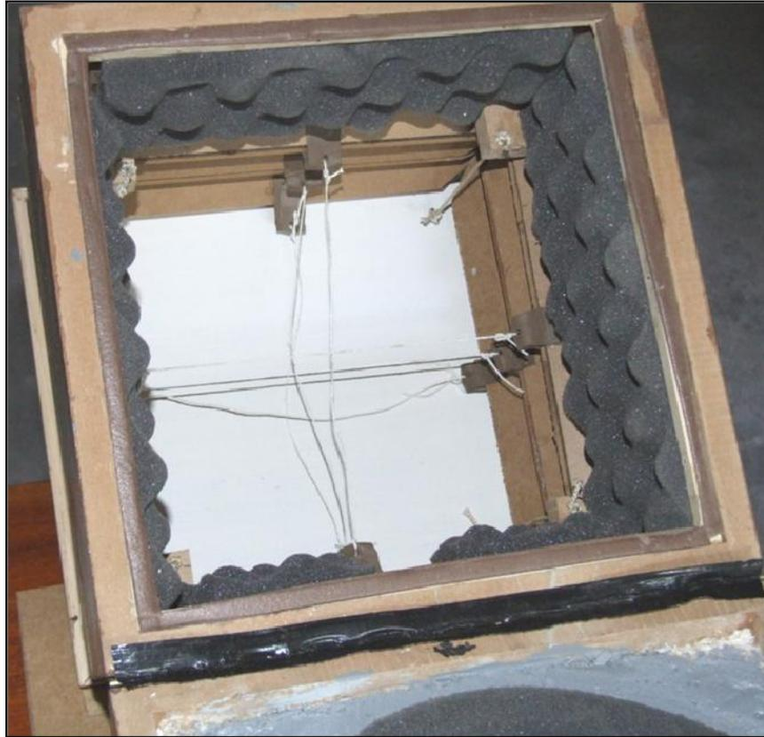
La réserve vue de l'intérieur. Le fond est peint en blanc de façon à faciliter le fonctionnement du capteur IR.
